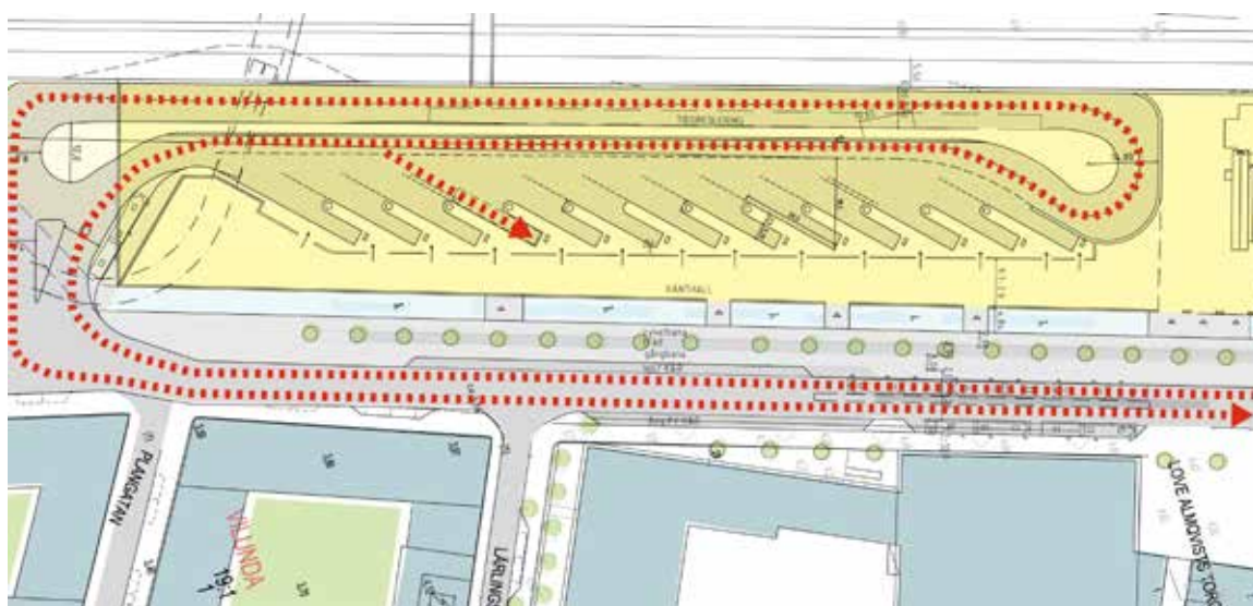
Studerad principlösning för bussterminalen. Bild: AIX Arkitekter.
