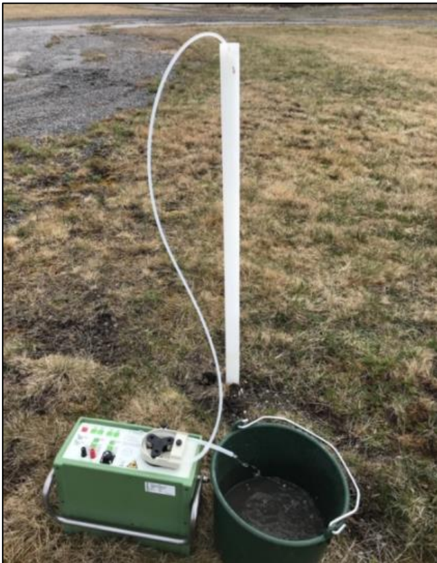
Figur 2: Grundvattenprovtagning med peristaltisk pump.
