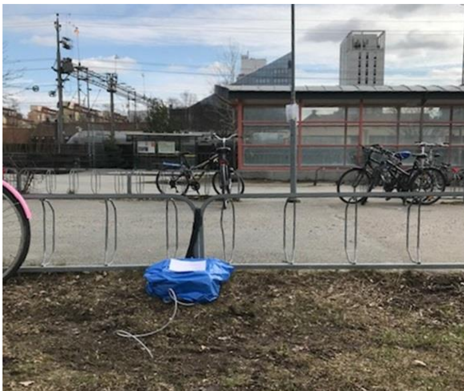
Figur 5 Givaren i MP2 där den grävts ner i jorden. Givaren är nedgrävd rakt under där kabeln går ner i marken. Tåg och spårområde syns i bakgrunden.
