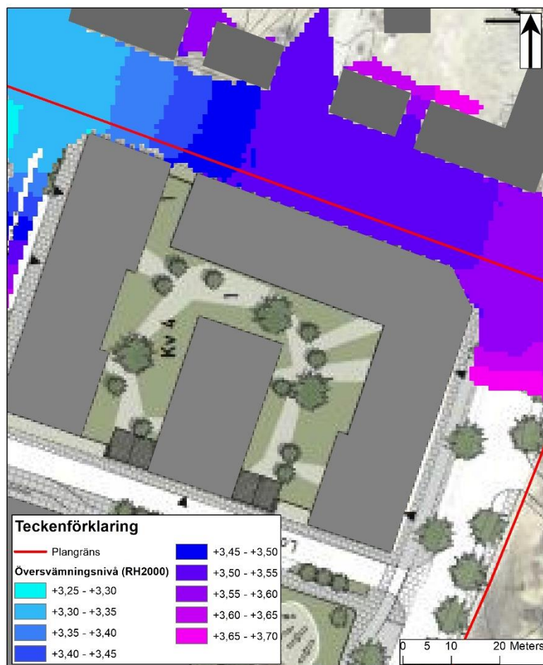
Figur 15: Översvämningarnivåerna för kvarter 4:s sida mot Anton Tamms väg där vattenansamlingar inträffar vid byggnadens fasad. Observera att endast översvämningarnivåerna mellan +3,25 och +3,70 illustreras.
