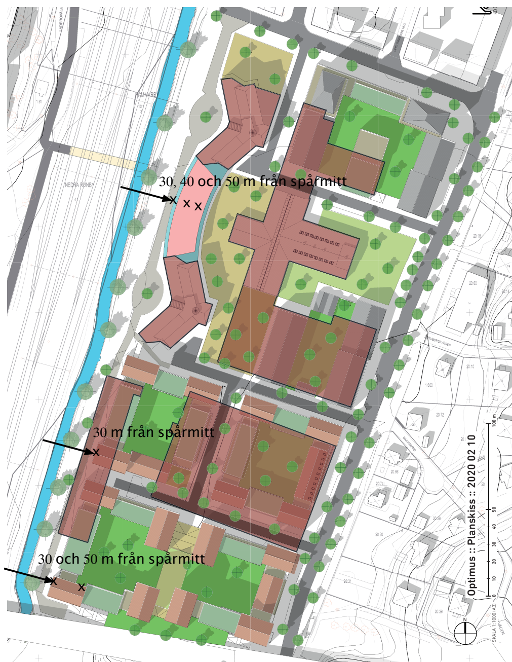
Figur 1.1 De planerade husen i projekt Optimus ligger som närmast ca 30 m från spårmittpå närmsta spår. Kryssen visar planerade mätpunkter.
