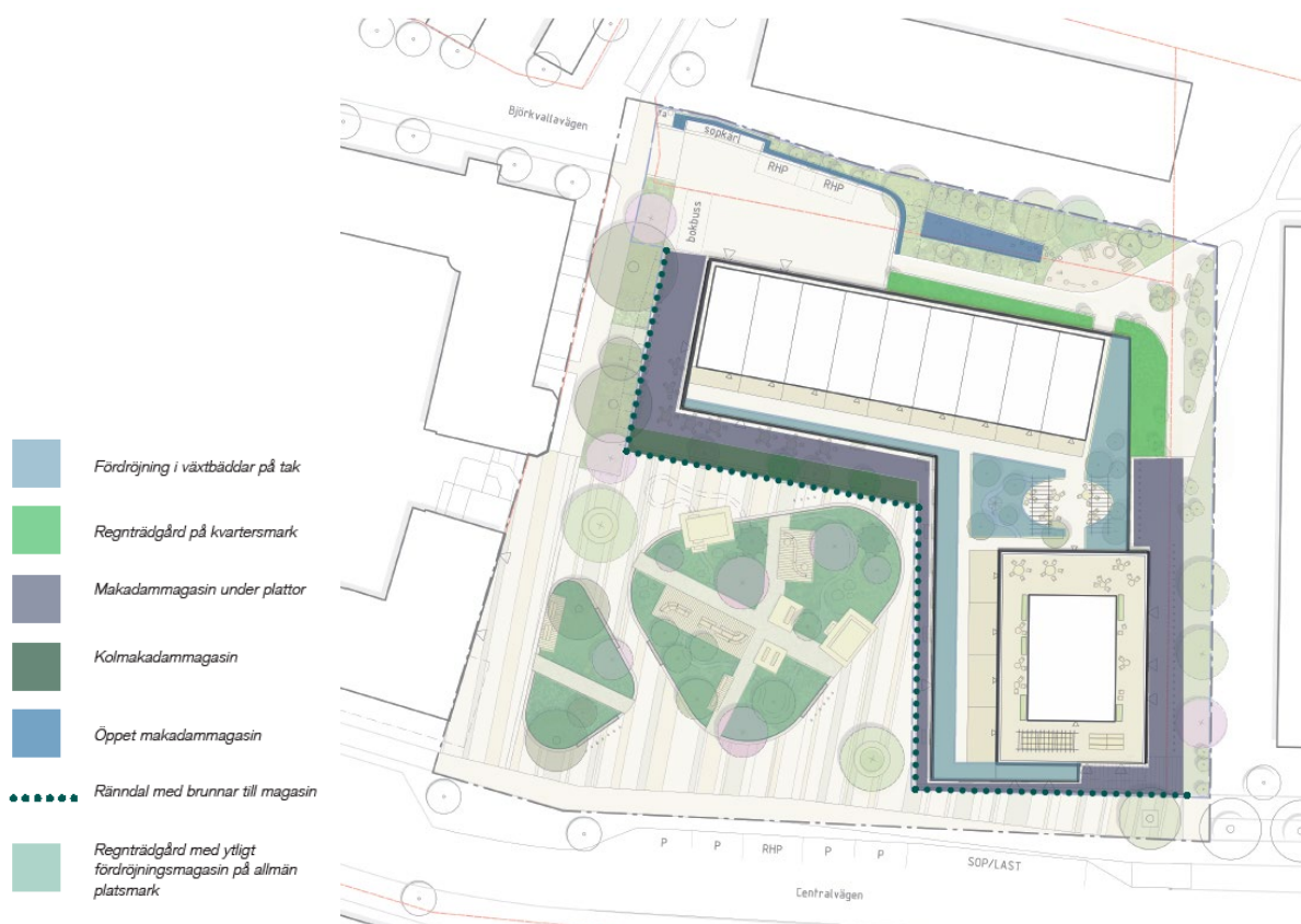
Figur 70. Föreslagen dagvattenhantering. Källa: Topia landskapsarkitekter, 2025.
