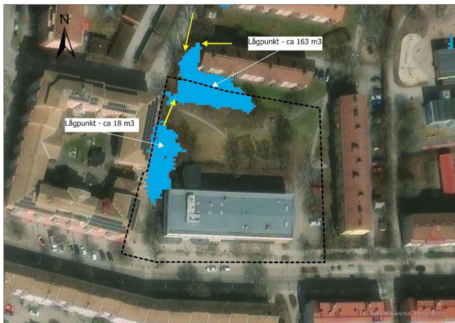
Figur 86. Lågpunkter (blått) inom planområdet (streckad svart). Gula pilar visar flödesriktningen till lågpunkterna. Källa: Dagvattenutredningen, WSP, 2025.
