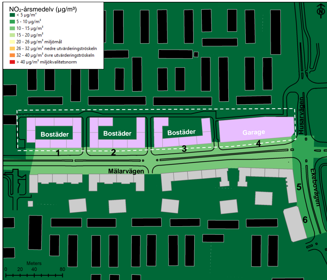
Figur 11. Årsmedelvärden NO 2 i µg/m 3 i utbyggnadsalternativet år 2040. Normvärdet som skall klaras är 40 µg/m 3 och miljömålet 20 µg/m 3 . Resultaten avser halter i µg/m 3 två meter ovan marknivå.
