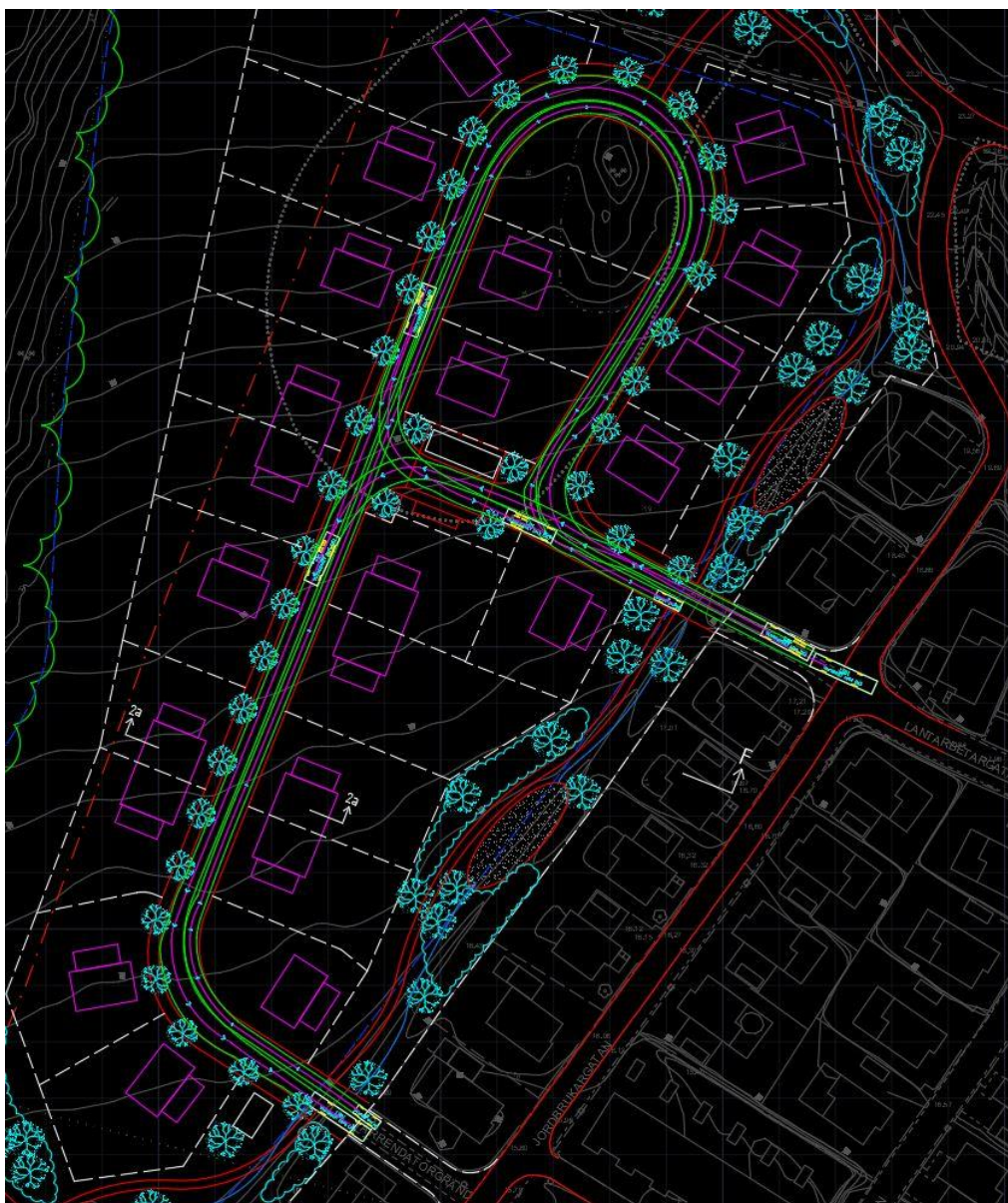
Figur 7-7. Körspårsanalys för sopbil i bostadsområdet, som visar att det är möjligt för sopbil att nå samtliga hushåll i området. Bildkälla: AFRY
