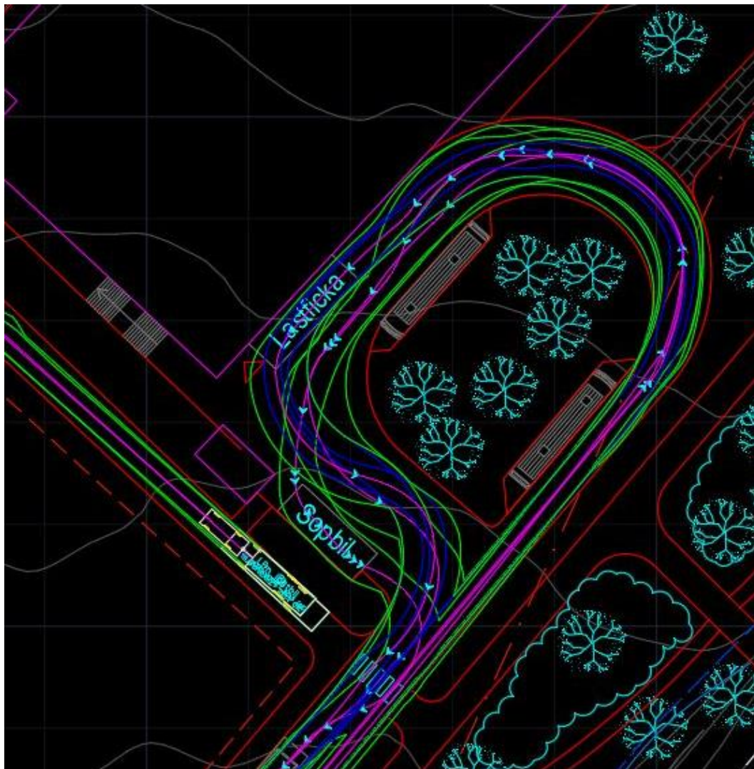
Figur 7-5. Körspårsanalys för sopbil i området vid sporthallen, som visar att vägar och vändplats är utformade på ett sätt som säkerställer sopbilarnas framkomlighet i området. Bildkälla: AFRY
