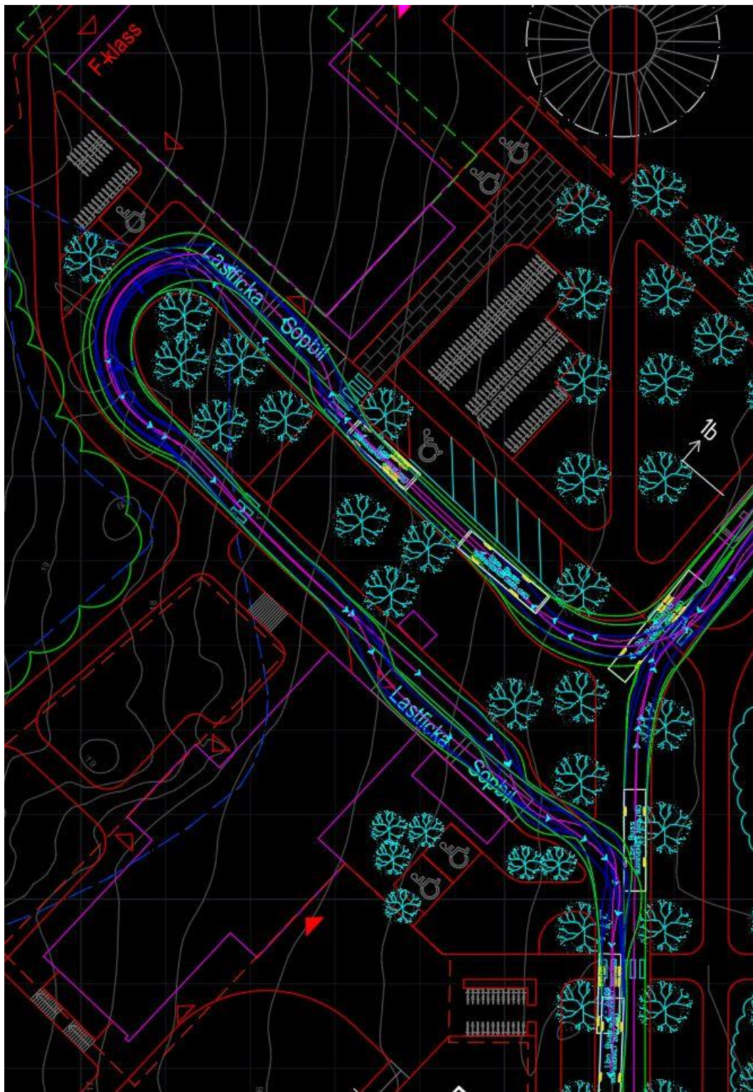
Figur 7-2. Körspårsanalys för sopbil i området vid skola och förskola, som visar att vägar och vändplats är utformade på ett sätt som säkerställer sopbilarnas framkomlighet i området. Bildkälla: AFRY
