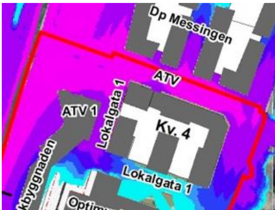
Figur 8. Översvämningssituation vid byggnad ATV 1 vid BHF i Väsbyån.
