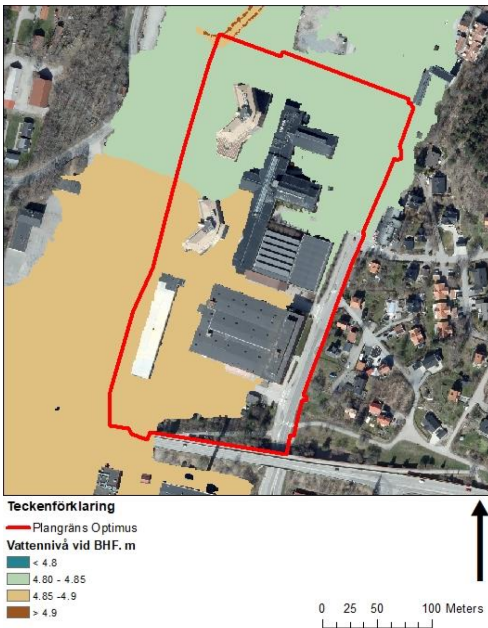
Figur 4: Översvämningsutbredning och vattennivåer vid BHF i Väsbyån vid dagens förhållanden.
