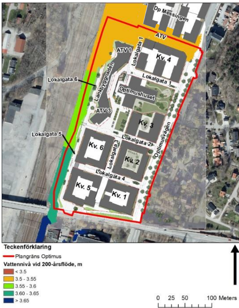
Figur 3: Översvämningsutbredning vid 200-årsflöde efter exploatering i Optimus. OBS! Ingen modellering med den framtida höjdsättningen i Optimus har gjorts men den bedöms ha minimal påverkan på resultatet jämfört med dagsläget. Därför har, i figuren, nivåer vid 200-årsflöde applicerats på den framtida höjdsättningen.
