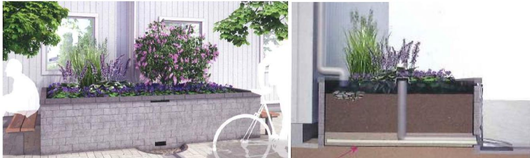
Figur 14 Till vänster: exempel på en upphöjd växtbädd för hantering av takvatten. Till höger: sektion av regnbädd med tätduk så att vatten inte riskerar att skada grundläggningen (Movium, 2015).
