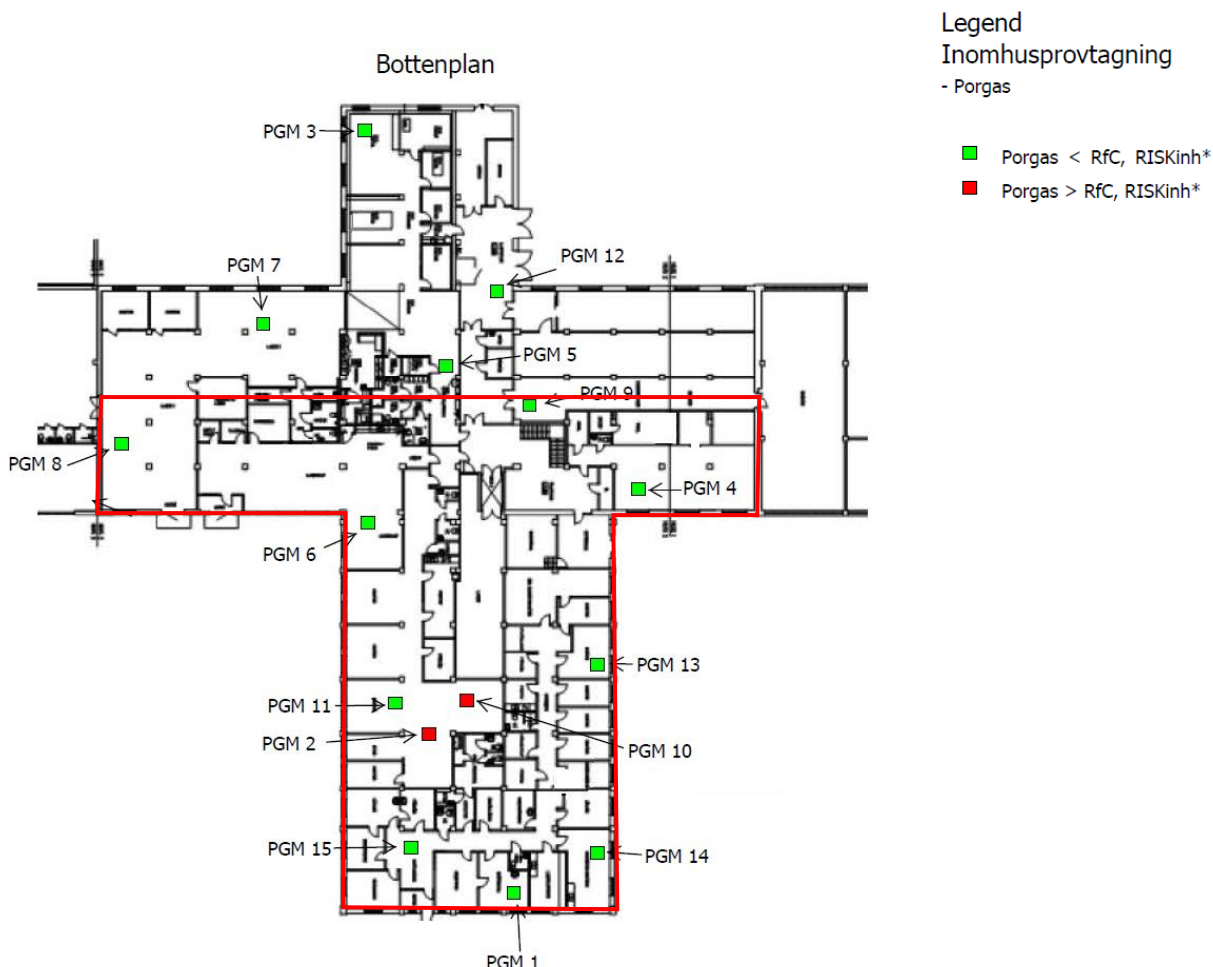
Figur 5. Provtagningspunkter avseende klorerade lösningsmedel under betongplatta inom "Optimushuset" (DeKa 2021).
